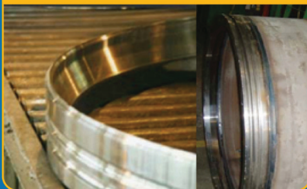
Aro Reparado con una Nueva Sección Delantera
