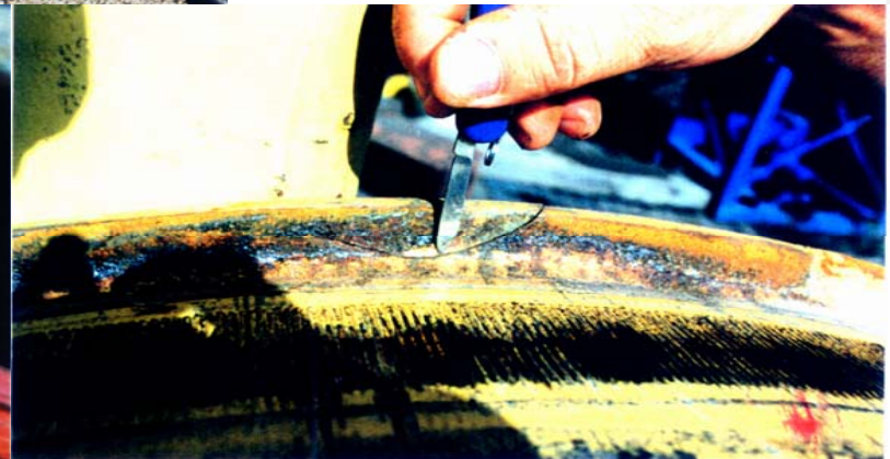
Sección trasera quebrada en la zona de contacto.
