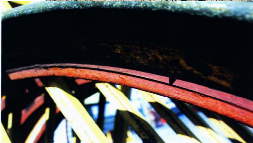
Desgaste en la zona de contacto del flange.
